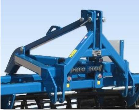
L'attelage à chapes catégorie n°2 assure robustesse et sécurité. L'attelage de forme triangulaire et le pivot à l'avant permettent de garder la direction du tracteur. Le châssis est autodirectionnel. Monté sur galets, il oscille, et suit sans effort la surface du sol. Les ressorts limitent son débattement et le recentrent en souplesse. Ainsi, l'ÉCOROULEAU se dirige et se contrôle aisément en toutes conditions.
