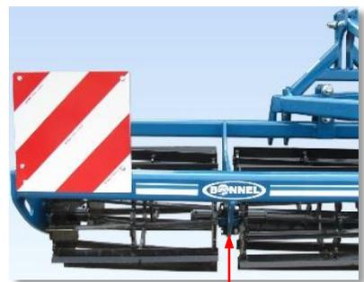
L'espace non travaillé au niveau de la jonction des rouleaux est comblé par les pneumatiques du tracteur qui vont écraser la végétation non détruite par l'ÉCOROULEAU. L'interculture est brisée sur toute la largeur de l'outil.
